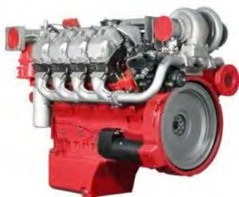
**Deutz series TCD2015** - это мощные 6-ти и 8-ми цилиндровые дизельные двигатели для промышленного применения с верхним расположением клапанов (OHV), горизонтальным валом отбора мощности, с жидкостным охлаждением ориентированные на эксплуатацию в нормальных климатических условиях. Выпускаются мощностью от 489 л.с. (360 кВт) до 670 л.с. (500 кВт), с турбокомпрессором и охлаждением воздуха наддува.
