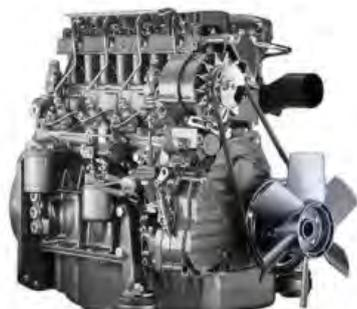
**Двигатели Deutz series 2011** - это 4-х тактные 2-х, 3-х, 4-х цилиндровые дизельные двигатели для мобильной техники средней мощности с верхним расположением клапанов (OHV), горизонтальным валом отбора мощности, с воздушным или жидкостным охлаждением ориентированные на эксплуатацию в нормальных климатических условиях. Выпускаются мощностью от 31 л.с. (23 кВт) до 88 л.с. (65 кВт), с турбонаддувом и без.
