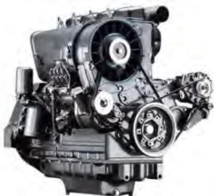
**Двигатели Deutz series 912** - это 4-х тактные 3-х, 4-х, 5-ти, 6-ти цилиндровые дизельные двигатели для профессиональной и бытовой техники с верхним расположением клапанов (OHV), горизонтальным валом отбора мощности и принудительным воздушным охлаждением ориентированные на эксплуатацию в нормальных условиях. Выпускаются мощностью от 47 л.с. (34 кВт) до 111 л.с. (82 кВт). Модели двигателей Deutz серии 912 W оснащены системой двухступенчатого сгорания топлива.
