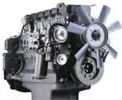
**Двигатели Deutz series 1013** - это 4-х тактные 4-х и 6-ти цилиндровые дизельные двигатели для промышленной и строительной техники с верхним расположением клапанов (OHV), горизонтальным валом отбора мощности, с жидкостным охлаждением ориентированные на эксплуатацию в нормальных и тяжелых климатических условиях. Выпускаются мощностью от 154 л.с. (115 кВт) до 313 л.с. (233 кВт). Модели двигателей Deutz серии 1013 выпускаются с турбонаддувом и без, могут поставляться с электронным управлением.
