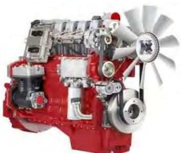
**Deutz series TCD2013** - это 4-х тактные 4-х и 6-ти цилиндровые дизельные двигатели для мобильной техники средней мощности с верхним расположением клапанов (OHV), горизонтальным валом отбора мощности, с жидкостным охлаждением ориентированные на эксплуатацию в нормальных климатических условиях. Выпускаются мощностью от 173 л.с. (129 кВт) до 325.9 л.с. (243 кВт), с турбокомпрессором и охлаждением воздуха наддува.
