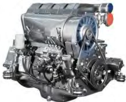
**Двигатели Deutz series 914** - это 4-х тактные 3-х, 4-х, 5-ти, 6-ти цилиндровые дизельные двигатели для профессиональной и бытовой техники с верхним расположением клапанов (OHV), горизонтальным валом отбора мощности и принудительным воздушным охлаждением ориентированные на эксплуатацию в нормальных условиях. Выпускаются мощностью от 59 л.с. (44 кВт) до 189 л.с. (141 кВт). Модели двигателей Deutz серии 914 выпускаются с турбокомпрессором и системой охлаждения воздуха наддува и без.
