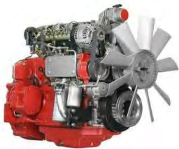
**Deutz series TCD 2012** - это 4-х тактные 4-х и 6-ти цилиндровые дизельные двигатели для мобильной техники средней мощности с верхним расположением клапанов (OHV), горизонтальным валом отбора мощности, с жидкостным охлаждением ориентированные на эксплуатацию в нормальных климатических условиях. Выпускаются мощностью от 88.5 л.с. (66 кВт) до 208 л.с. (155 кВт), с турбонаддувом, с механическим или электронным инжектором.
